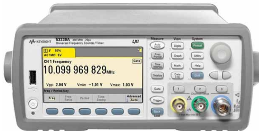
Рис. 5. Частотомер 53230A имеет два входных канала с полосой пропускания до 350 МГц и может быть оснащен третьим каналом с полосой пропускания до 6 ГГц (опция 106) или до 15 ГГц (опция 115).
