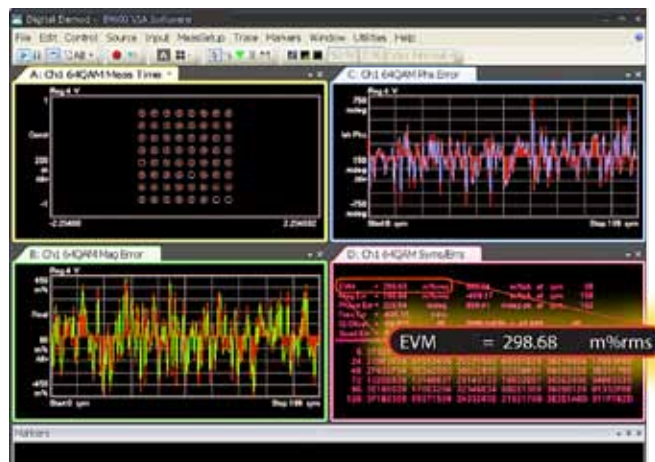
Рис. 3. Сигнальное созвездие и амплитуда вектора ошибки модулирующего сигнала 64-QAM
