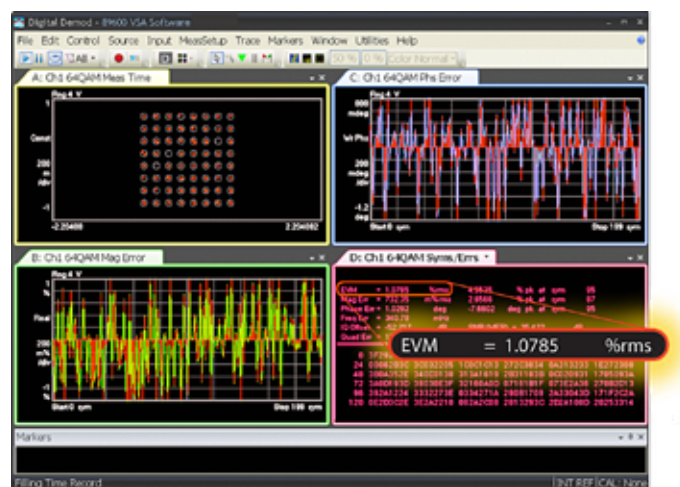
Рис. 5. Сигнальное созвездие и амплитуда вектора ошибки модулирующего сигнала 64-QAM с добавленным шумом.
